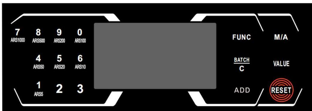
**Botón FUNC (Detección billetes dudosos)** - Al encender la máquina todos los métodos de detección se habilitan. Si uno de estos métodos detecta un error, la máquina detendrá su operación, permitiéndole retirar el billete dudoso. Un código de error aparecerá en el visor.
